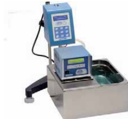
Utilización de un termostato DIGITERM para controlar la temperatura en la medida de viscosidad por medio de recirculación de líquido.
