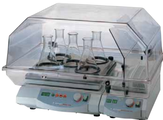
Incubator-1000 configurado con módulo calefactor y campana alta + agitador Unimax 1010.
