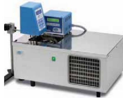
Baño termostático FRIGITERM con el kit de adaptación código 1001625 para trabajar junto al viscosímetro rotacional.
