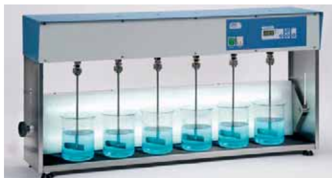
Floculador "Flocumatic" con elementos de iluminación en posición vertical. 6 plazas.
