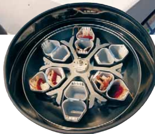
Imagen de la centrífuga con cabezal y vasos con doble compartimento para bolsas de sangre triples o cuádruples de 500 a 800 ml.
