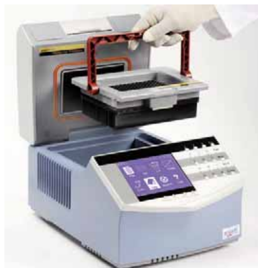
Termociclador puerta abierta con sistema calefactor en la contrapuerta para evitar condensaciones.
