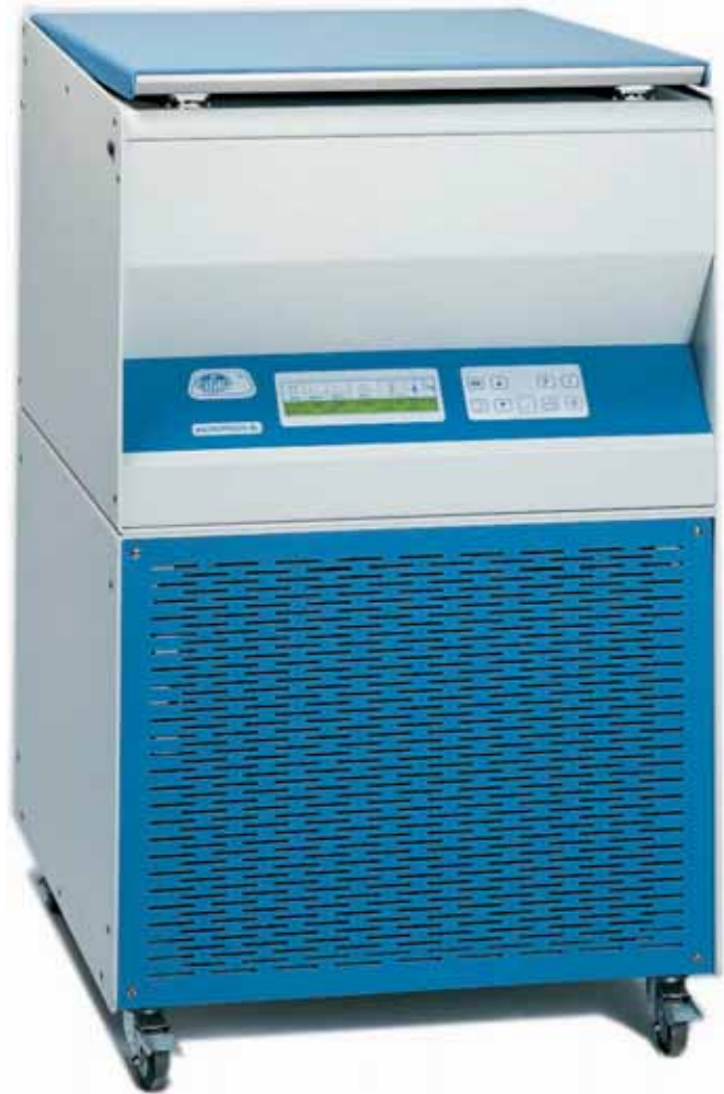
Modelo "Macrofriger-BL" refrigerada con selector de temperatura regulable de 0 a 30 °C.
