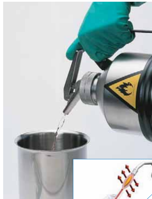
Dispensador con válvula y muelle de descompresión.
