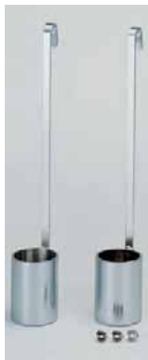
Copas con asa. Modelos DIN 53211 N° 4 y Ford ASTM D-1200.
