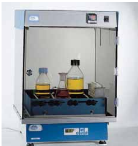
Agitador orbital y de vaivén "Rotabit" acoplado a la cámara de incubación "Boxcult".
