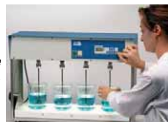
Floculador "Flocumatic" con elementos de iluminación en posición horizontal. 4 plazas.
