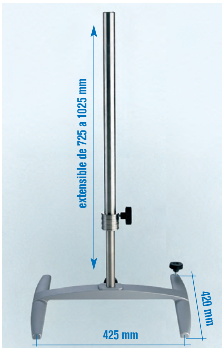
SOPORTE DOBLE T TELESCÓPICO Varilla en acero inox. AISI 304 de 32 mm Ø. Altura de elevación desde 725 a 1025 mm. Para soportar pesos hasta 20 kg. Peso: 7,7 Kg. Compatible con la nuez código 5057022 (ver pág. 221). Código 5057011
