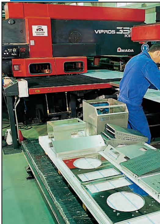
Unidad de troquelado y punzonado por control numérico, y corte por láser.
