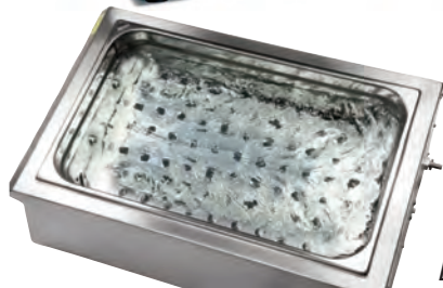
Detalle de la agitación por bomba de circulación interna.
