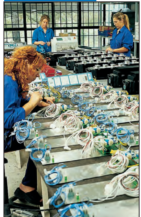
Ensamble y montaje de los elementos electrónicos y de regulación y control.
