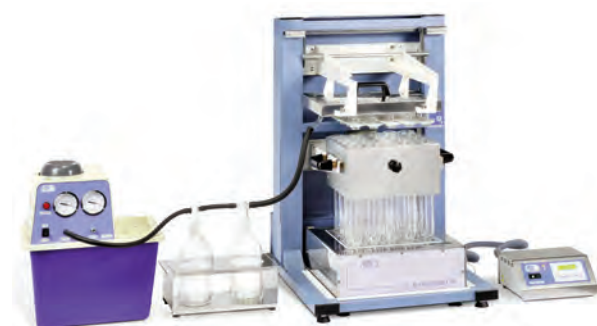
Bomba de recirculación “Scrubber” Bloque digestor
