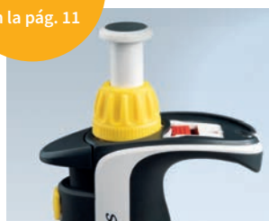
Técnica Easy Calibration: Ajuste sin herramientas
